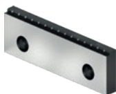
台阶式卡爪 带硬质合金夹持台阶, 3 mm。 用于压入夹持最高达 58 HRC 的硬化材料。
