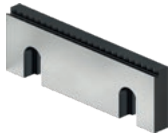
台阶式卡爪 带夹持台阶, 3 mm。 用于压入夹持最高达 22 HRC 的未硬化材料。
