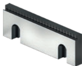
台阶式卡爪 带夹持台阶, 5 mm。 用于压入夹持最高达 22 HRC 的未硬化材料。
