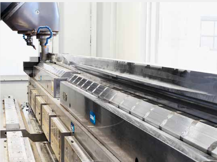
Um Wärmeverzug auszugleichen, werden die Vierkantprofile sowohl am Fuß als auch seitlich per Magnet gespannt. Drei Aufspannungen genügen, um die Zungen fix und fertig zu bearbeiten.
