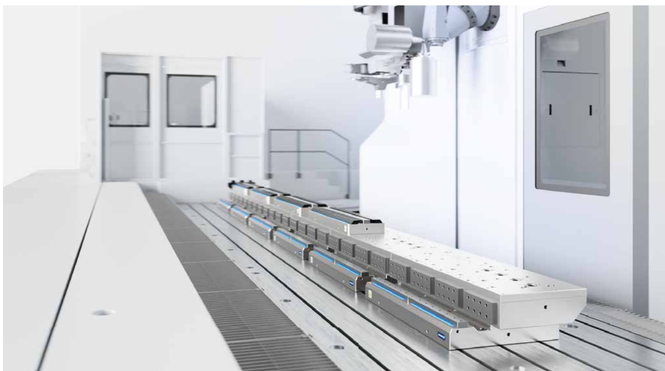
Bearbeitung der Rille in einer Vollschiene, Zerspan- tiefen bis 47 mm in einem Schnitt, die vertikale Spannung sorgt für eine optimale Spanabfuhr, dies erhöht die Bearbeitungsqualität bei gleich- zeitiger Reduktion vom Werkzeugverschleiß.
