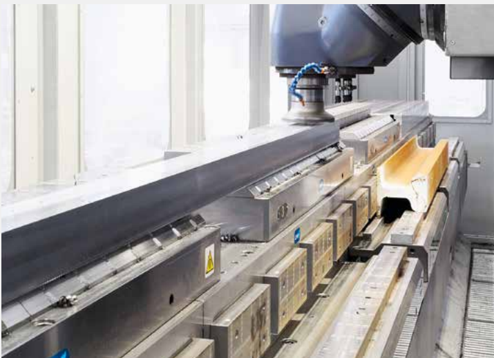
Vor dem Rillenfräsen werden die Gleiselemente mit dem Planfräser bearbeitet. Die Werkstücke sind am Fuß sowie seitlich am Gleiskopf gespannt.
