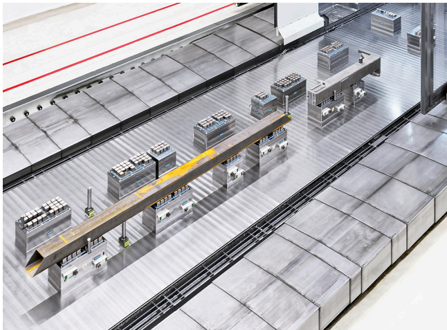
La tavola della fresatrice a portale misura 12.500 mm x 3.000 mm. Una parete divisoria consente la lavorazione in modalità shuttle Immagine: SCHUNK
