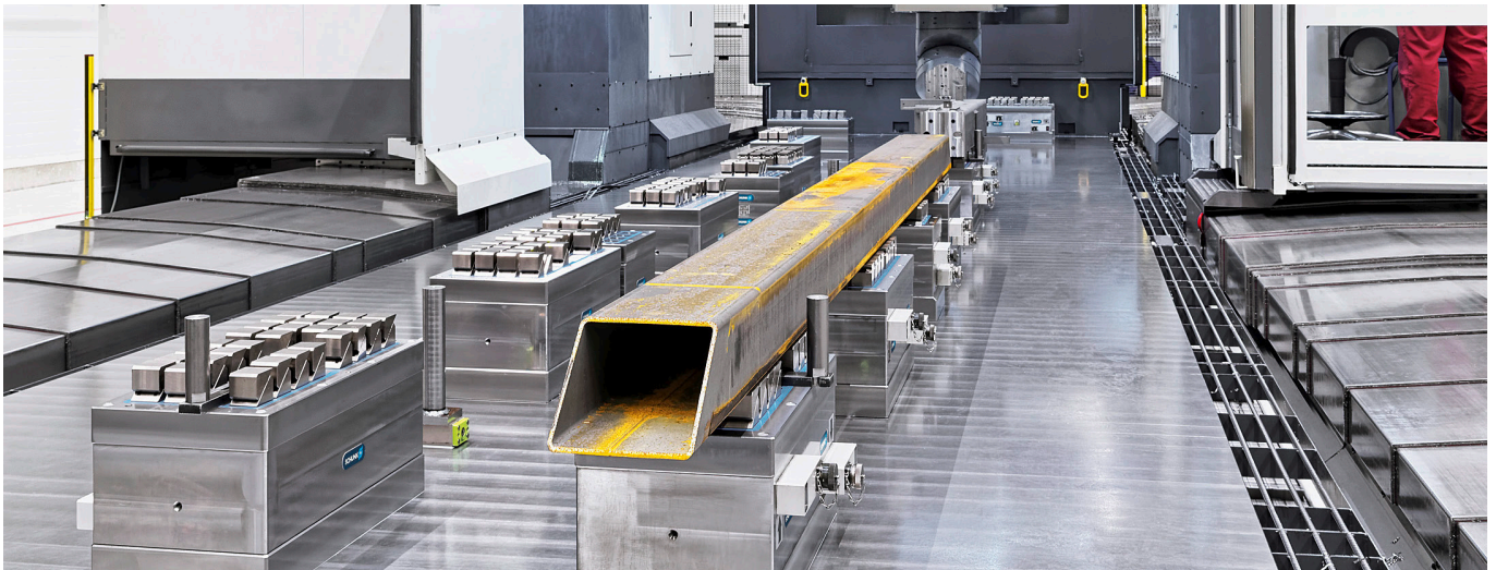
Con l'aiuto delle soluzioni magnetiche SCHUNK, è possibile lavorare particolari di carpenteria di grande formato fino a 12.000 mm su una fresatrice a portale Correa OX M. Immagine: SCHUNK
