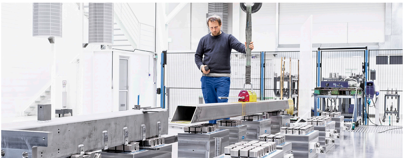
Poiché il piano della macchina è privo di cave e fori, è molto facile da pulire. Una volta posizionati i moduli di serraggio, i tubi e i telai di saldatura vengono posizionati sui moduli di serraggio MAGNOS tramite carroponete e fissati. Immagine: SCHUNK
