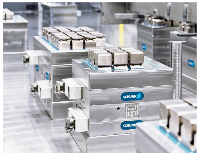
La tavola macchina è completamente ricoperta da una lamiera di acciaio e fresata in superficie. Su questa superficie lucidata a specchio i moduli di serraggio possono essere posizionati molto facilmente. La distanza ideale dei magneti a doppia faccia è stata provata in una serie di test. Immagine: SCHUNK
