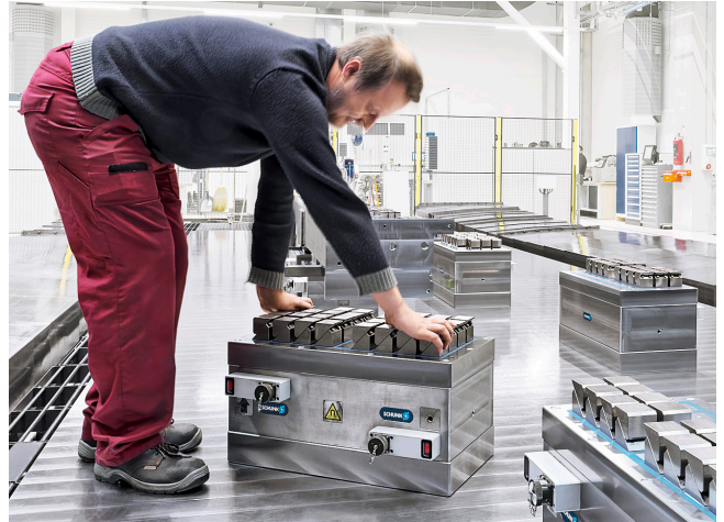
Non appena il piano magnetico inferiore è disattivato, l'operatore della macchina può spostare manualmente il blocco di serraggio senza sforzo Immagine: SCHUNK
