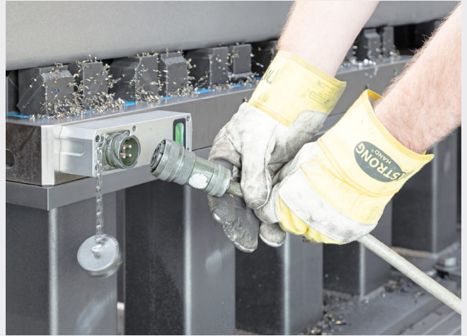
Display di stato brevettato: "Verde" indica lo stato di magnetizzazione. Ora il pezzo è saldamente bloccato su questo modulo di serraggio magnetico. Immagine: SCHUNK
