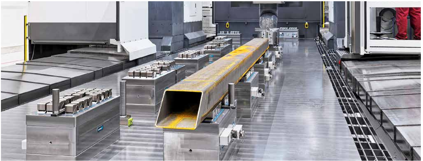
Mithilfe der SCHUNK Magnetspannlösung lassen sich auf der Portalfräsmaschine Correa OX M großformatige Schweißkonstruktionen bis 12.000 mm bearbeiten. Bild: SCHUNK
