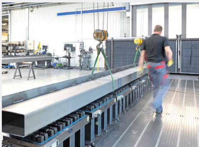
Dank des beispielhaften Kabelmanagements können sich die Mitarbeiter sicher und ohne Stolperfallen an der Maschine bewegen. Bild: SCHUNK
