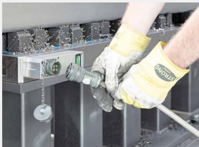
Patentierte Statusanzeige: „Grün“ zeigt den Magnetisierungsstatus an. Nun ist das Werkstück an diesem Magnetspannmodul fest gespannt. Bild: SCHUNK
