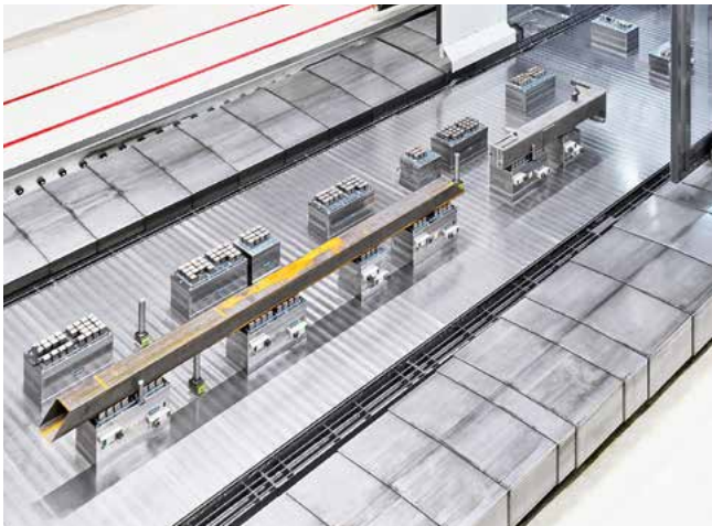
Der Maschinentisch der Portalfräsmaschine misst 12.500 mm x 3.000 mm. Eine Trennwand ermöglicht eine Bearbeitung im Pendelbetrieb. Bild: SCHUNK
