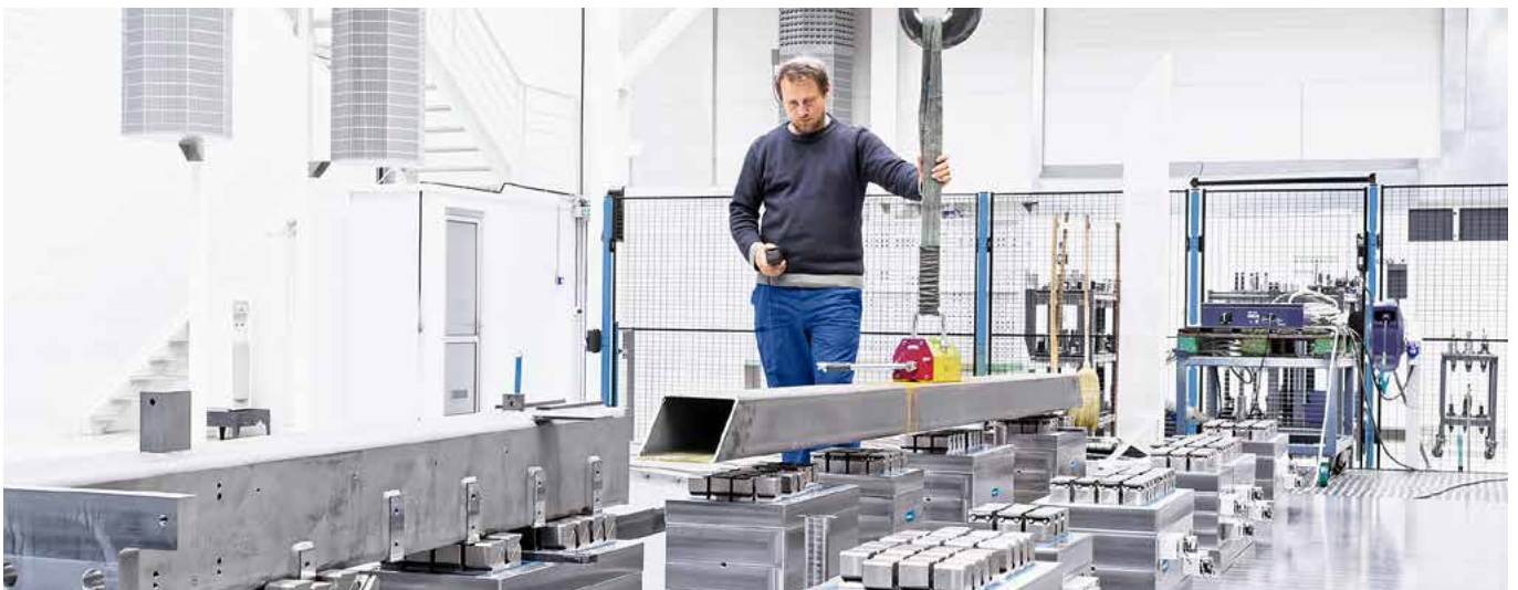
Da der Maschinentisch frei von Nuten und Bohrungen ist, lässt er sich sehr einfach reinigen. Sind die Spannmodule positioniert, werden die Rohre und Schweißrahmen per Kran auf die MAGNOS Spannmodule aufgelegt und gespannt. Bild: SCHUNK
