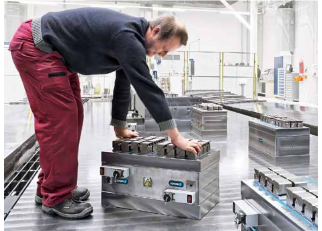
Sobald die untere Magnetplatte deaktiviert ist, kann der Bediener den Spannblock mühelos per Hand verschieben. Bild: SCHUNK
