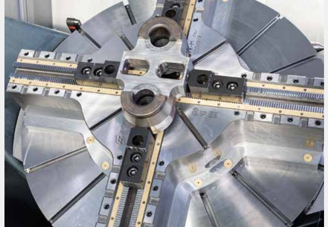
Die Bearbeitung dieser komplex geformten Führungsaufnahme für Rüttelköpfe, die in der Gießerei den Sand abschütteln, ist mit dem Drehfutter ROTA ML flex 2+2 kein Problem
