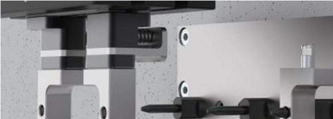
Wechselfingersystem für die Anpassung an unterschiedliche Produktgeometrien.
