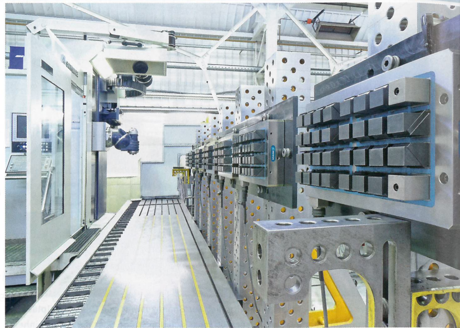
4 Bei dieser Spannlösung sind die Magnetmodule seitlich am Maschinentisch angebracht, sodass die Werkzeugmaschine auch für andere Bearbeitungsaufgaben genutzt werden kann (© Schunk)
