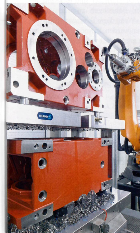
5 Spannsynergie: Im unteren Stockwerk dieser Spannlösung wird deformationsarm per Magnet fixiert, im oberen per Direktspeisung mittels Nullpunktspannsystem (© Schunk)
