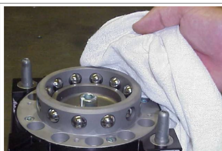
Pulire le sfere e la parte esterna della SWK
