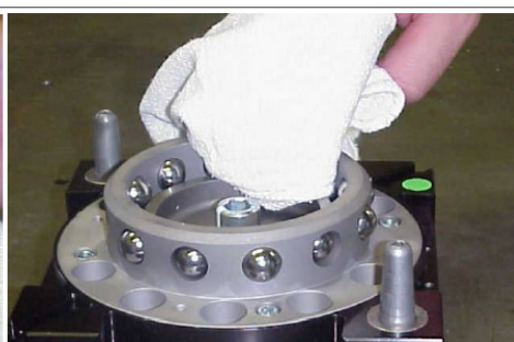
Pulire le sfere, le camme e la parte interna della SWK
