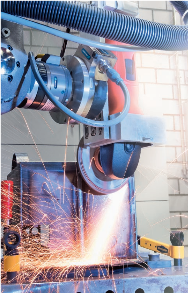
机器人与 SCHUNK FT 传感器之间的力/力矩反馈可实现壁炉送风室自动磨削质量的显著提高。
