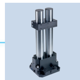
Sistema de ensamble con pilares
