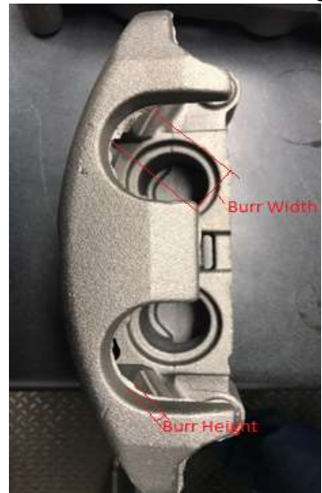
Définition de la hauteur et de la largeur de la bavure
