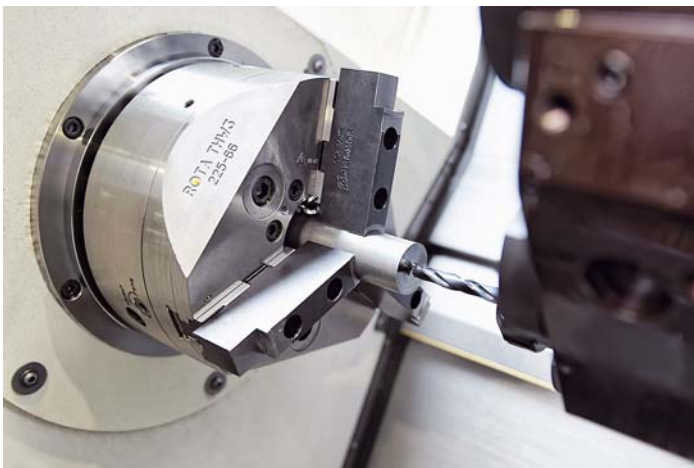
Bei der Stangenbearbeitung zahlt sich die große Futterbohrung des Backenschnellwechselfutters aus. Mithilfe der modular nutzbaren Schutzbüchsen lässt sich das Futter bei Bedarf von vorne verschließen. Bild: Schunk
