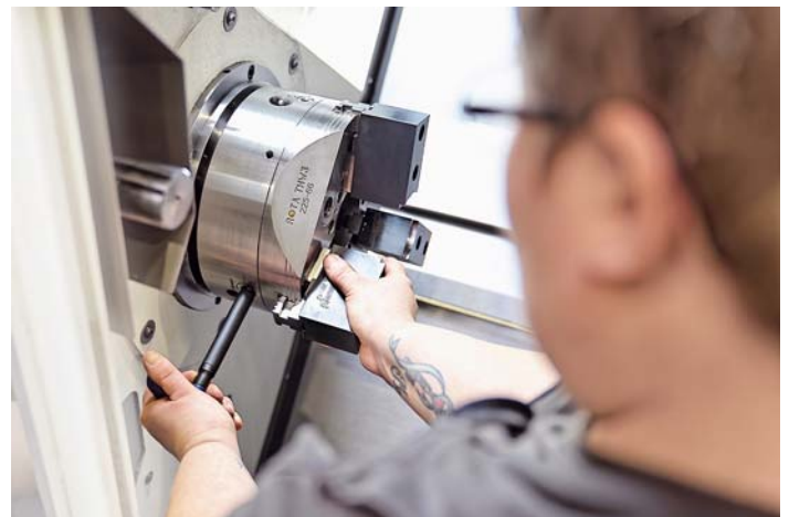
Das Rota THW3 überzeugt mit einer sehr hohen Backen-Wechselwiederholgenauigkeit bis < 0,02 mm. Wenige Handgriffe genügen, schon hat Sabrina Schmidt die drei Spannbacken präzise gewechselt. Bild: Schunk
