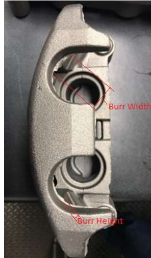
Grathöhe (burr height) bzw. -breite (burr width)
