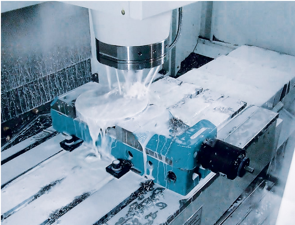
grefors Mit weichen Aufsatzbacken und eingeprägter Spannkantur zum Spannen und Bearbeiten von runden Werkstücken With soft top jaws and milled clamping contour for the clamping and machining of round workpieces
