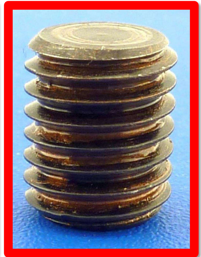
Spannschraube muss umgehend nachschiert werden
