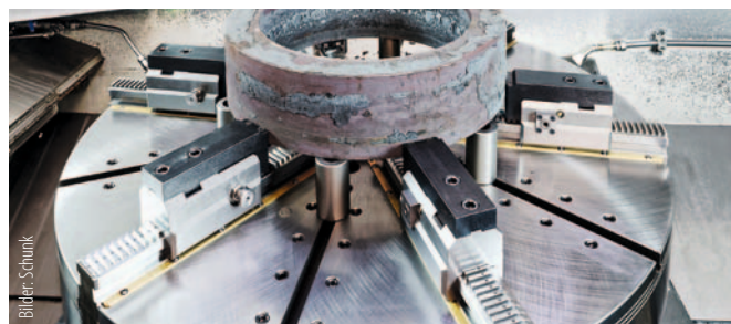
Bei der Rohteilspannung gewährleisten die pendelnden Spannbacken des Schunk Rota NCR 1250 eine optimale Zentrierung des Werkstücks. Beim Spannvorgang liegen die Bauteile auf geschliffenen Säulen so dass eine optimale Pendelung gewährleistet ist.
