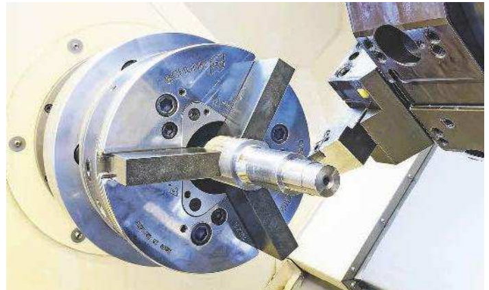
Beim Schunk Rota THW 500 können die bis zu 8 kg schweren Spannbacken schnell gewechselt werden. Bild: Schunk
