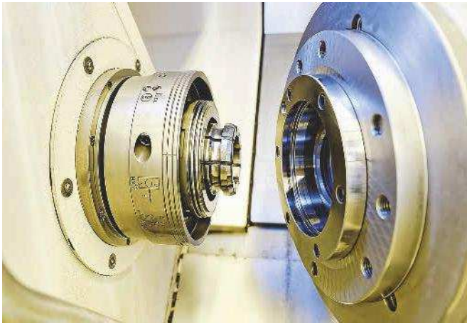
Mithilfe des Flexkegels wird das Drehfutter hochgenau zentriert. Bild: Schunk
