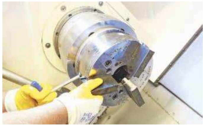
Beim Schunk Rota THW 500 können die bis zu 8 kg schweren Spannbacken schnell gewechselt werden. Bild: Schunk
