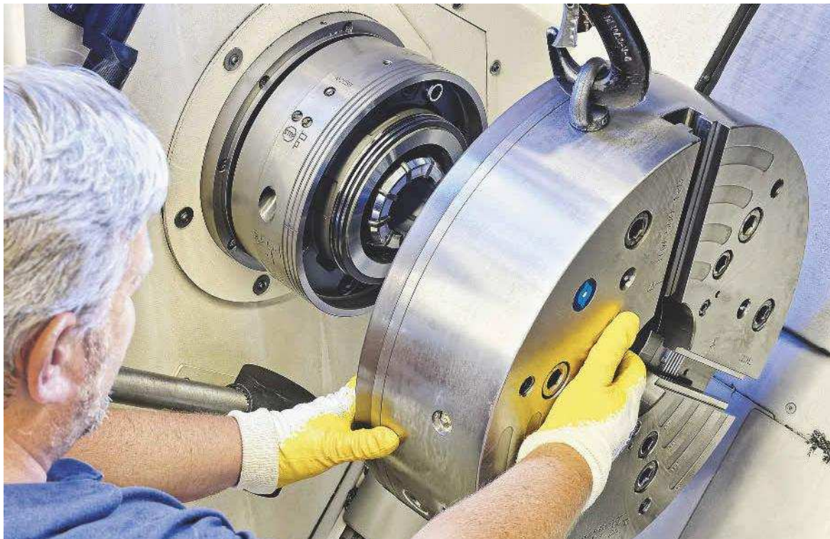
Mit dem Schunk FSW Futterschnellwechselsystem ist der komplette Drehfutterwechsel bei LMT Fette innerhalb von nur 15 Minuten erledigt, inklusive Reinigen, Ölen und Einlagern des Drehfutters. Das Rota THW Kraftspannfutter, das Thomas Frankenberger hier mit wenigen Handgriffen wechselt, wiegt über 200 kg. Bild: Schunk
