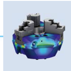
FE-Parameteroptimierung für reduzierte Kerkspannungen und höchste Steifigkeiten. FE parameter optimization for reduced notch stresses and highest rigidity.
