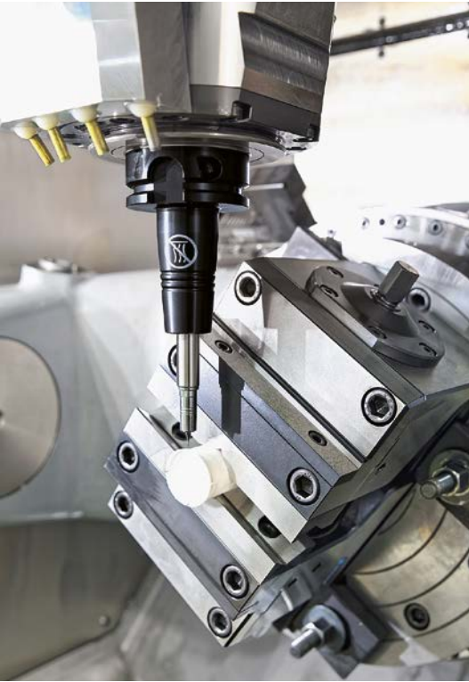
2 Wenn es besonders eng zugeht, nutzt Aero Pump Werkzeugverlängerungen Tri-bos SVL-Mini von Schunk. Mit ihnen können wie hier auch sehr kleine Durchmesser hochgenau gespannt werden (© Schunk)
