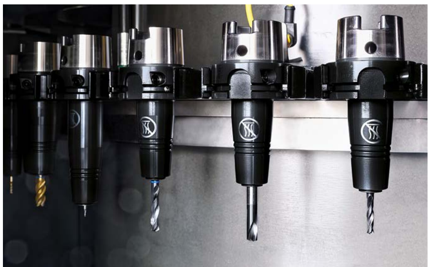
4 Die Hydrodehnspannfutter von Schunk in ihren zwei Längenvarianten 90 und 120 mm, einsatzbereit im Magazin des kompakten 5-Achs-Bearbeitungszentrums Hermle C 12 U bei Aero Pump (© Schunk)
