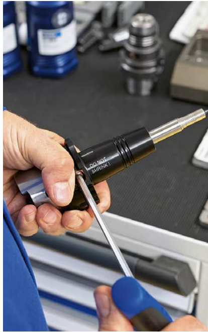
3 Innerhalb weniger Sekunden lässt sich die Werkzeugverlängerung im Hydrodehnspannfutter fixieren (© Schunk)
