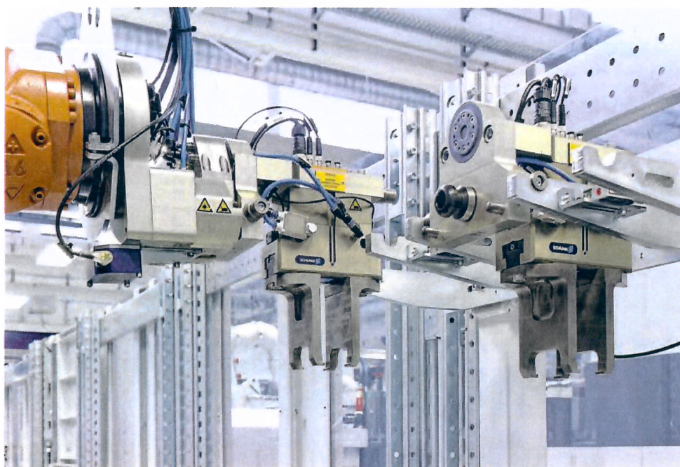
Auch die beiden Beladegreifer sind mit einer Schnittstelle zur Vero-S-NSR-Roboterkupplung ausgestattet. So können sie bei Bedarf schnell und einfach eingewechselt werden.
