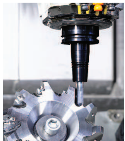
Erstklassige Oberflächen statt Rattermarken: Mit der Umstellung auf Tendo Slim 4ax hat Ingersoll bei der Bearbeitung der Spanräume von Schlichtfräsern erhebliche Effizienzeffekte erzielt.
