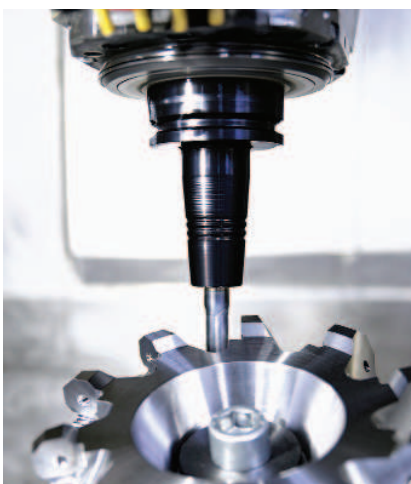
Die Spanräume zwischen den einzelnen Zähnen des Schlichtfräasers erfordern eine hohe Oberflächenqualität. Mit Tendo Slim 4ax war es möglich, eine hohe Prozessstabilität zu erzielen und einzelne Prozessschritte zu eliminieren.
