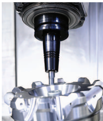
Beim Schlichtfräsen spielt Tendo Slim 4ax seine Stärken aus. Die Aufnahme erzielt auf Anhieb brillante Oberflächen.
