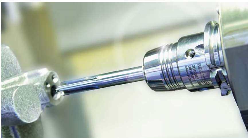
3 Beim Reiben von Gussteilen für Industriekunden setzt Heidelberg auf Schunk Tendo zero. Bei diesem Hydrodehnspannfutter ist die Winkellage des Werkzeugs in der Maschine einstellbar; Rundlauffehler lassen sich so eliminieren (© Schunk)
