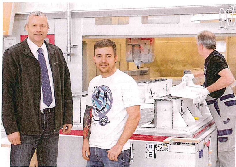
Schunk-Fachberater Hermann Winterer (links) im Gespräch mit Eduard Minderlen (rechts), Leiter CNC bei Schüsche Solid Solutions. Im Hintergrund rüstet der Maschinenbediener gerade einen Waschtischrohling, während der zweite Rohling mit Tendo E compact bearbeitet wird. Bild: Schunk
