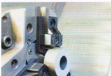
Bild 4 a-c: Insgesamt zehn harte Kralleneinsätze bietet Schunk mittlerweile für unterschiedliche Durchmesser und Spannbereiche
