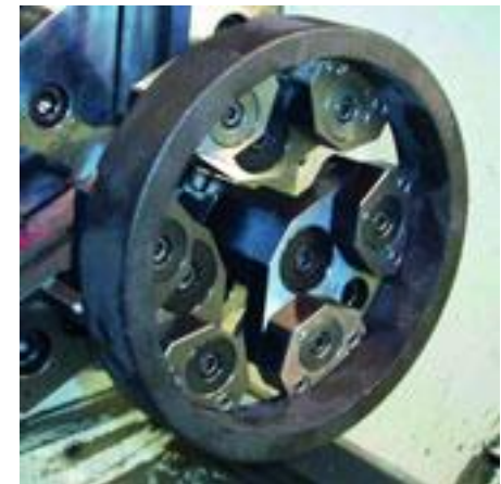
Einsatzbeispiel einer 12-Punkt-Pendelbacke für Innenspannung
