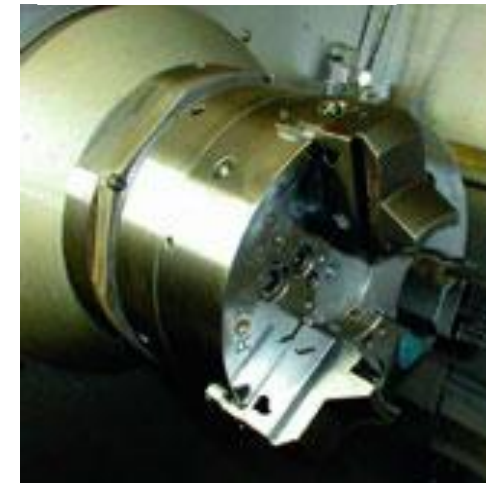
Einsatz der Spannlösung auf einer INDEX G300Flex
