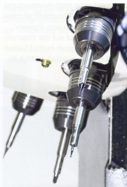
Bild 3: Je nach Anwendung kombiniert das Team bei Strub die Schunk Hydro-Dehnspannfutter mit Werkzeugverlängerungen oder Zwischenbüchsen
