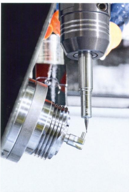
Bild 2: Mikroteile, wie diese Stanze aus nichtrostendem Stahl 1.4021 (X20 CR13), werden bei Strub mit bis zu 24.000 min -1 bearbeitet
