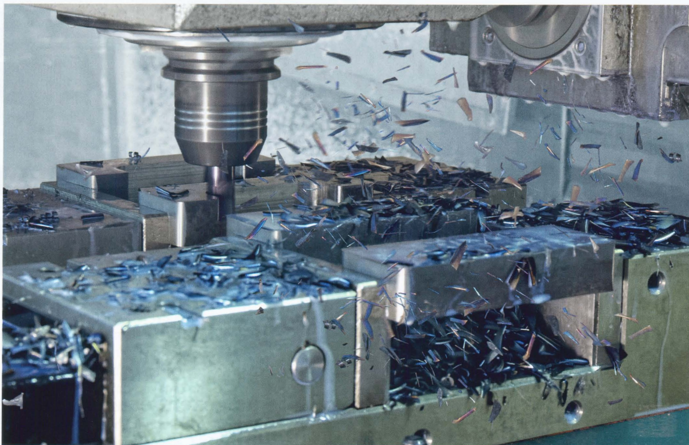
Bild 1: TENDO E compact hält auch höchsten Anforderungen in der Volumenzerspanung stand
