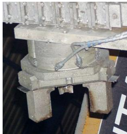
Abbildung 2: Greifer mit Staubabdeckung unter Einsatzbedingungen
