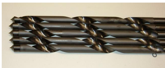
Abbildung 1: Mit DLC beschichtete Bohrer
