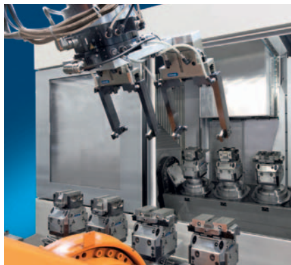
Links: Mit dem Nullpunktspannsystem lassen sich direkt gespannte Werkstücke, Spannmittel oder komplette Paletten schnell und präzise einwechseln. Rechts: Kraftspannblöcke werden mittels Greifer eingewechselt und von je einem Vero-S gespannt.
