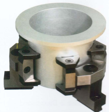
Bild 8: Dieses Werkstück wird über 24 Spannpunkte fixiert
