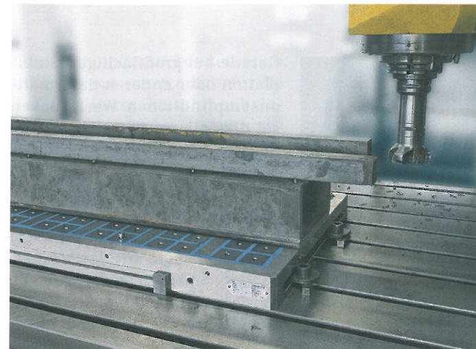
Rugel nutzt die Magpos Quadratpolplatten zur Spannung unterschiedlichster Werkstücke.
