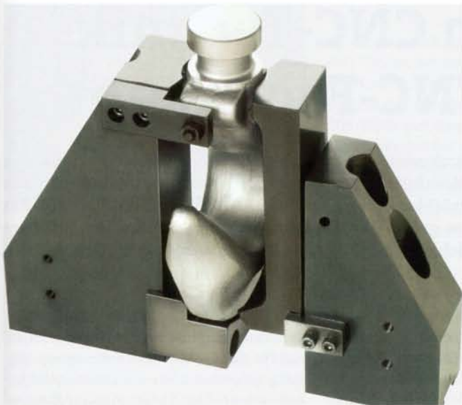
Selbst Werkstücke mit außergewöhnlichen Konturen lassen sich mithilfe von Sonderbacken sicher spannen.
