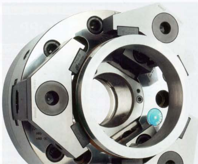
Gegenüber einer konventionellen Aufspannung im 3-Backen-Futter verbessert ein 6-Punkt-Pendel die Rundheitsgenauigkeit rechnerisch um den Faktor 17.
