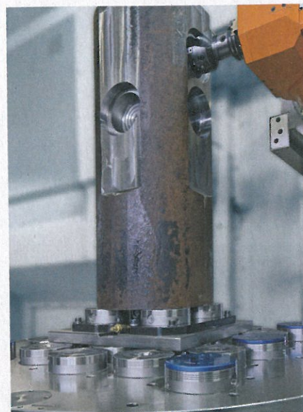
Bild 5: Einzugskräfte bis 40.000 N gewährleisten auch bei hohen Querkräften eine maximale Präzision.
