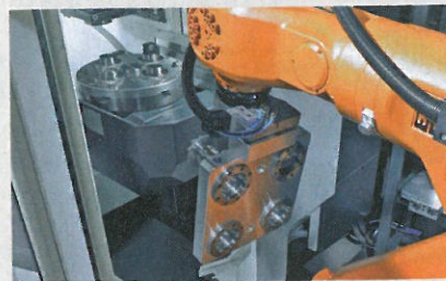
Fertigung rund um die Uhr: Das Nullpunktspannsystem Vero-S NSA plus sorgt bei der automatisierten Maschinenbeladung für Genauigkeit und Prozesssicherheit.
