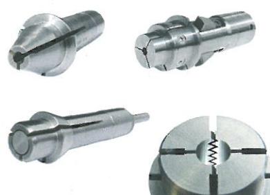
O. li.: Vorbauzange mit Hartmetall bestückt; o. re.: Spreizdorn mit wechselbaren Backen; u. li.: Spannzange mit Auswerfer; u. re.: Spannzange mit verzahnten Nuten
