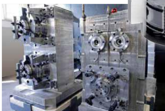
Die Spanntürme aus hochfestem Aluminium baut Ebro selbst. Sie sind bodenseitig mit Spannbolzen und an den Seiten mit Spannmodulen ausgerüstet.
