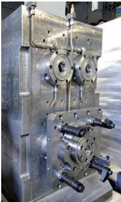
Die Spanntürme aus hochfestem Aluminium baut Ebro selbst. Sie sind bodenseitig mit Spannbolzen und an den Seiten mit Spannmodulen ausgerüstet.
