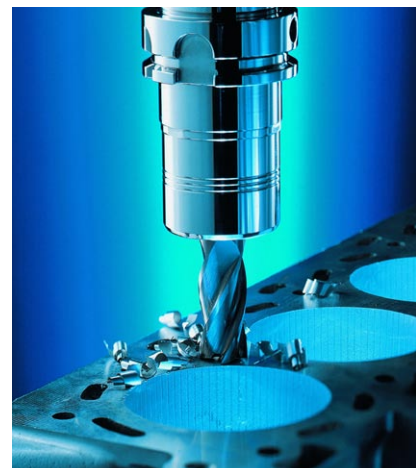
Die hohe Rundlaufgenauigkeit ist bei TRIBOS dauerhaft gewährleistet – auch nach mehreren Tausend Spannvorgängen.
