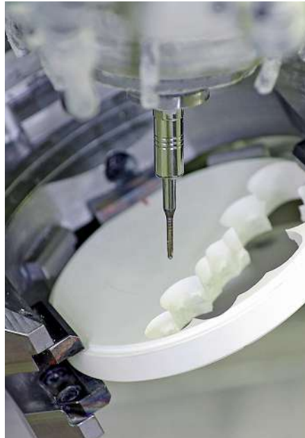
Bild 4: Beim Fräsen von Zirkon in der Dentaltechnik sorgt die Polygonspanntechnik für hohe Präzision.
