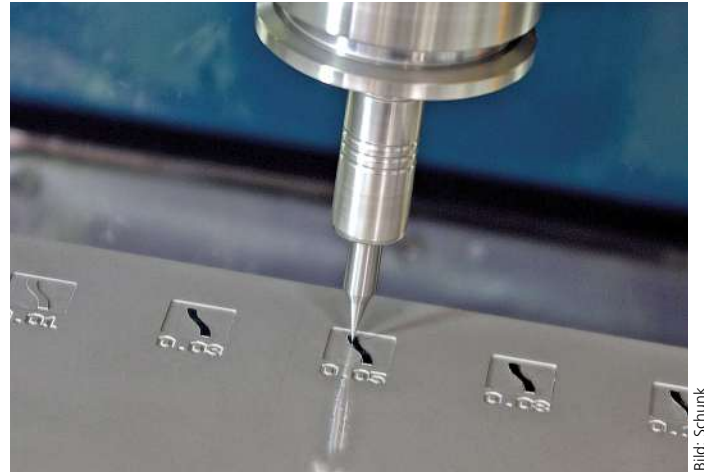
Bild 2: In Polygonspannfutter gespannte Fräser mit Schneidendurchmessern zwischen 0,1 und 0,03 mm für den Formenbau.
