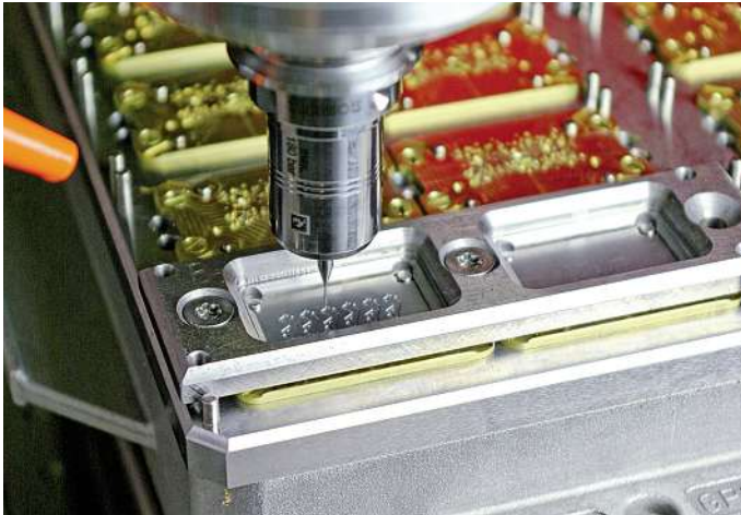
Bild 1: In der Uhrenindustrie ist das Tribos-Spannfutter weit verbreitet. Die filigranen Teile erfordern ein hohes Maß an Genauigkeit.
