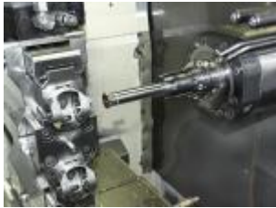
Achtschneidiges Reibwerkzeug in der einstellbaren Aufnahme DRHD im Einsatz auf einem Horizontal-Fräszentrum
