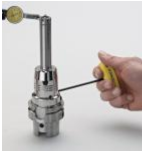
Kennzeichnend für die Hydrodehnspannfutter DRHD ist das einfache hochgenaue Einstellen des Rundlaufs
