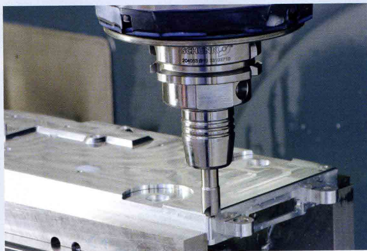
Präzisionsfase: Extrem präzise Anwendungen werden bei Sartorius weiterhin mit den bewährten Tendo-Hydro-Dehnspannfuttern von Schunk gefertigt.
