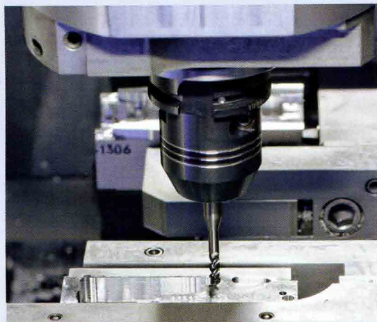
Tendo E compact von Schunk: Das Hydro-Dehnspannfutter ist präzise und preisgünstig zugleich. Bei identischen Ergebnissen konnte Sartorius die Werkzeughalterkosten um 40 Prozent senken.
