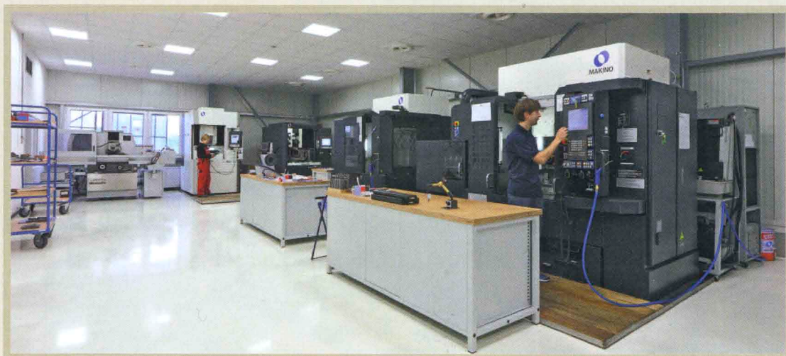
Bild 2. Die Fertigung bei Mitec vereint drei Kernkompetenzen: Fräsen, Senkerodieren und Drahterodieren
