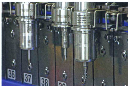
Bild 4. Werkzeugmagazin: Polygonspannfutter erzielen bei Mitec optimale Ergebnisse. Gefräst wird auf Hochpräzisionsmaschinen von Makino
