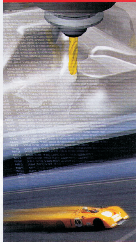
3 Die Kombination aus Sino-Universal-spannfutter und Tribos-Verlängerung wird beim Institut Dr. Foerster zum Problemlöser: Mit einem 10-mm-Bohrschruppfräser lassen sich bei 1500 min -1 und 100 bis 200 mm Vorschub selbst schwierigste Werkstückgeometrien vorschruppen
