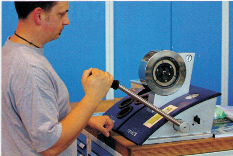
4 Sven Ferreli: »Neben der hohen Rundlauf- und Wechselwiederholgenauigkeit sowie der Wartungsfreiheit haben die Tribos-Verlängerungen einen weiteren Vorteil, sie lassen sich einfach und schnell spannen«
