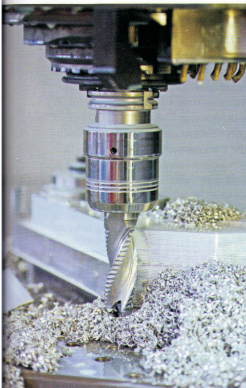
2 Mit dem ›Sino-R‹ werden bei einem 32-mm-Durchmesser Drehmomente bis 850 Nm souverän übertragen
