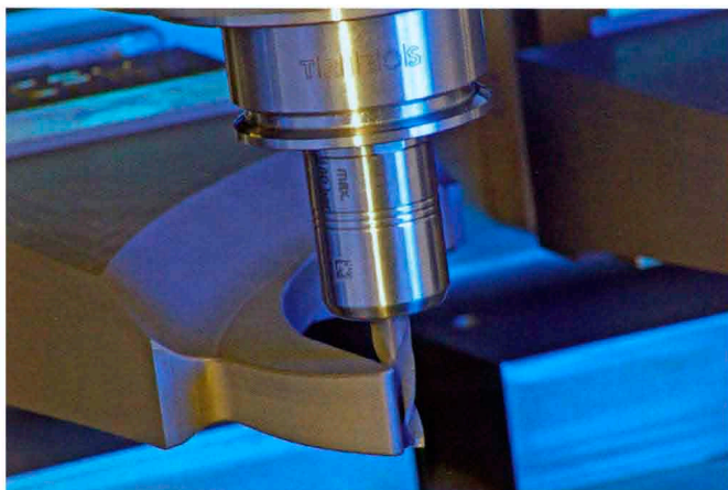
Bild 3 und 4: Mit der hochpräzisen Polygonspanntechnik sind perfekte Graphitoberflächen sicher
