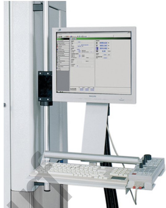
Abb. 10: Über spezielle Software-Module der Maschinensteuerung können die Motorenströme kontrolliert werden.
