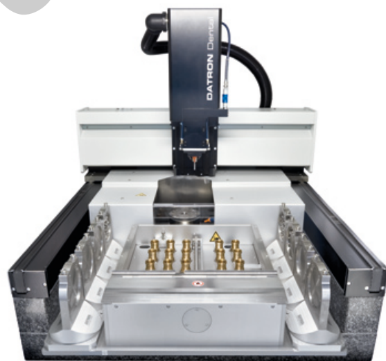
Abb. 7: Ein schwerer Granittisch unterstützt die Systemsteifigkeit.
