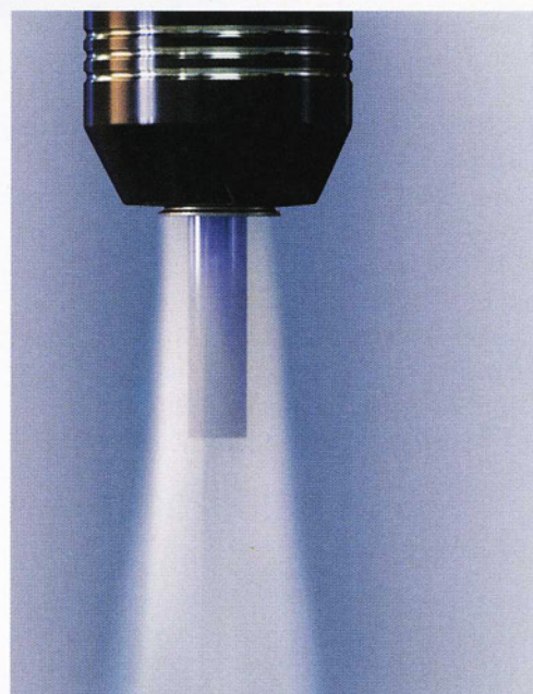
Ohne diesen Düseneffekt wird die Schneide nicht optimal mit Kühlschmiermittel versorgt.
