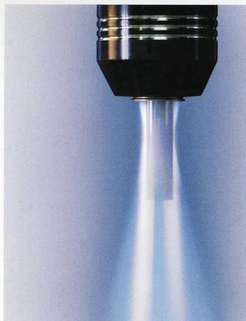
Die besondere Düsengeometrie der GZB-S sorgt für eine bessere Kühlmittelversorgung.
