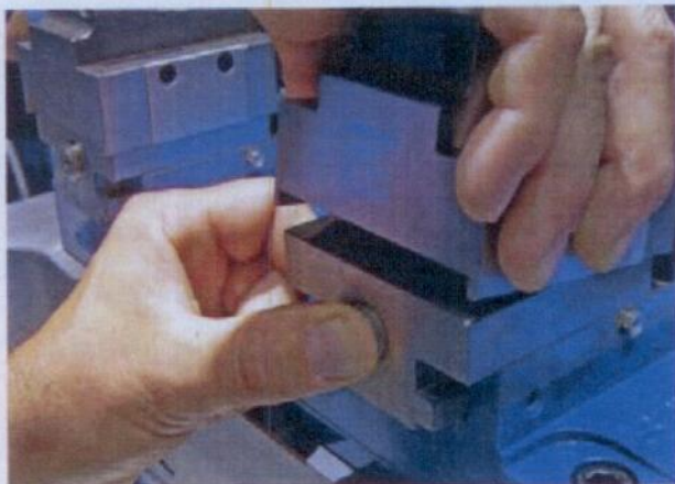
Bild 1: Backenwechsel per Knopfdruck: Die jüngste Innovation von Schunk sorgt auch bei stationä- ren Spannsyste- men für einen sekundenschnellen Backenwechsel.
