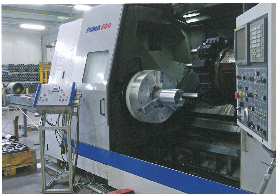
1 In Kombination mit den pneumatischen Kraftspannfuttern von Schunk sorgt die Steuereinheit Elke 24/2 für Präzision und Sicherheit beim Drehen von Rohren und Stangen
