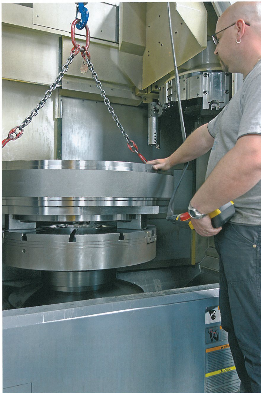
Bild 2: Kraft – Hub – Höhe. Beim hochpräzisen ROTA NCO sind alle drei Faktoren optimiert. Das macht es zu einem Spezialisten für große Präzisionsteile
