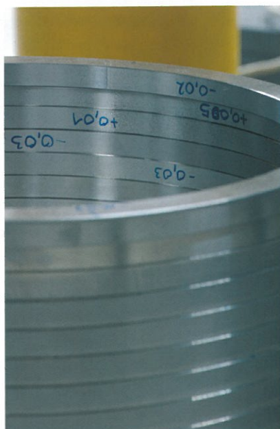
Bild 3: Große, dünnwandige Ringe präzise bearbeiten und dabei auch noch Kosten reduzieren. Mit Hilfe von ROTA NCR zeigt die Jarmet Metallbearbeitung aus Hattingen, wie es geht
