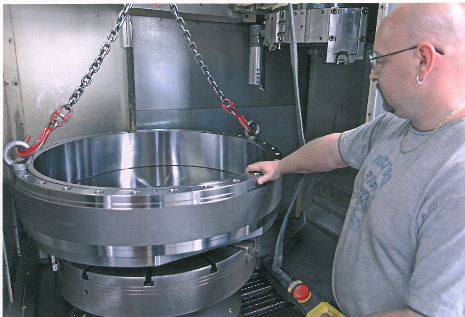
Bild 1: Spannkraft – Backenhub – Bau- höhe. Beim hochpräzisen ROTA NCO sind alle drei Faktoren optimiert. Das macht es zu einem Spezialisten für große Präzisionsteile
