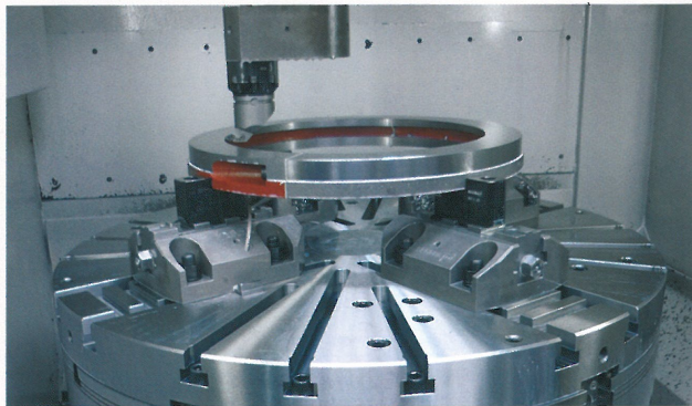
Bild 5: Spannklaue-kasten der Zukunft: Der durchdrachte SPK sorgt für Effizienz bei der Bearbeitung großer Drehteile
