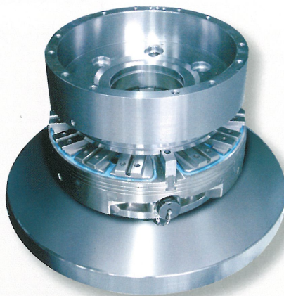
Bild 3: In Hybridfuttern wie dem ROTA NCM sind Zentrierfutter und Radialpolplatte miteinander kombiniert. Anwender profitieren von minimalen Rüstzeiten, deformationsfreier Spannung und null Vibrationen
