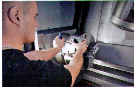
Maschinenbediener Alexander Gorr wechselt einen kompletten Backensatz des Rota THW plus in weniger als einer Minute
